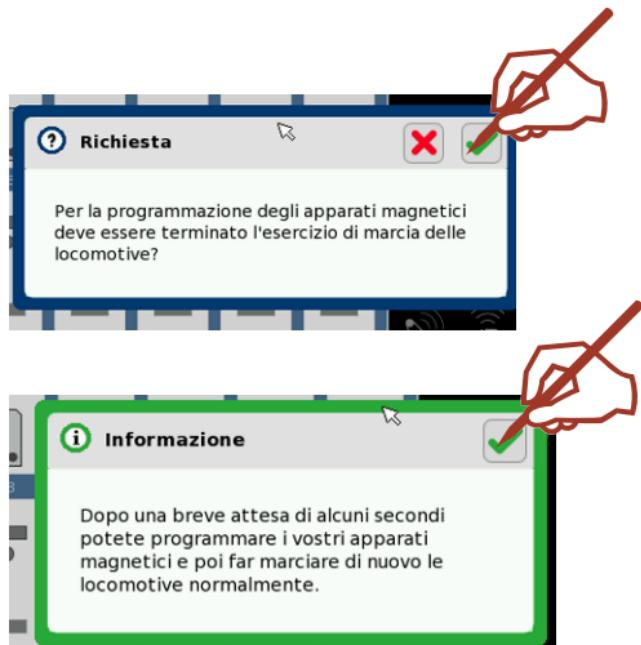
Premete il tasto "Stop", per interrompere l'alimentazione di corrente, e collegate il segnale alla connessione per il binario principale o per il binario di programmazione (pagina 18). A questo scopo si prega di fare attenzione al fatto che il ponticello di filo confezionato nella scatola (ponticello di programmazione) sia inserito nei morsetti sul lato inferiore del Decoder. Mediante una nuova pressione del tasto "Stop"ivate nuovamente l'alimentazione di corrente. Nella
